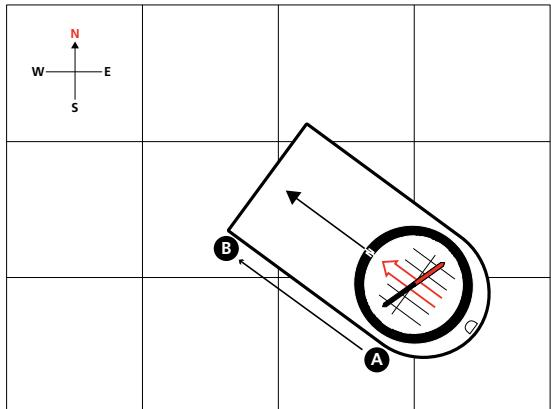
2. Поворачивайте капсулу до тех пор, пока ориентирующие линии не станут параллельны линиям меридианов на карте (символ N должен указывать на север).
