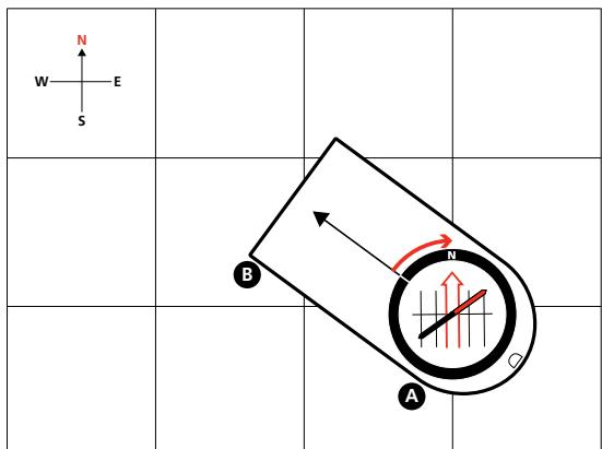
3. Держите компас параллельно земле на уровне пояса и поворачивайтесь до тех пор, пока стрелка компаса и ориентирующая стрелка не совпадут.
